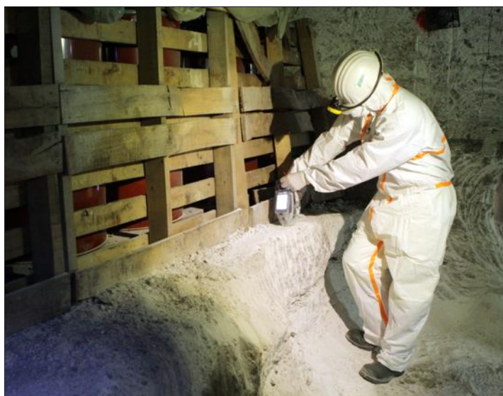
À l'aide d'un spectromètre à fluorescence X, Nicolas Pouyau vérifie que le site de reconditionnement des déchets a bien été décontaminé.
