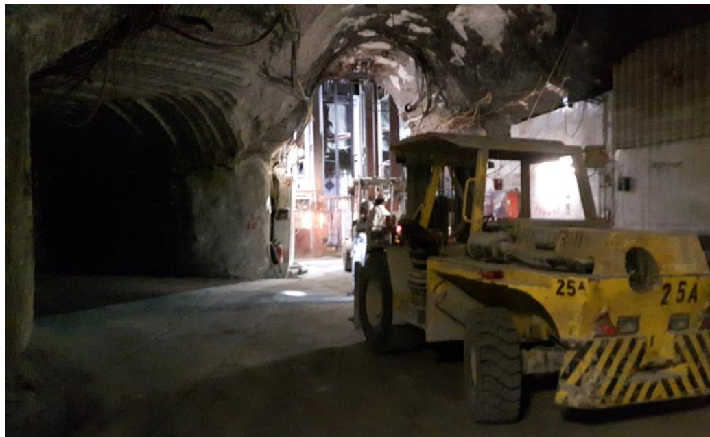
L'ascenseur au fond permet de remonter quatorze hommes à la surface, 750 mètres plus haut, en 2 minutes 30. PHOTO D.P.
