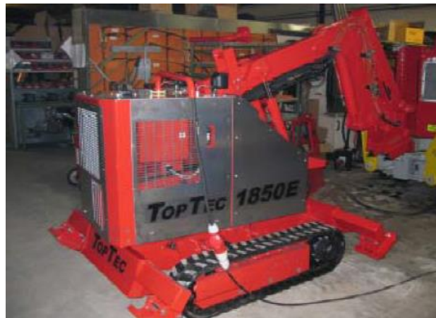
Figure 7 : Exemple d'engin électrique avec bras articulé pouvant effectuer tous types de travaux (source TopTec).
