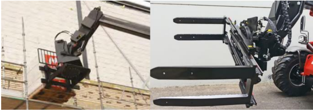
Figure 8 : Exemple de tête rotative permettant une préhension des Big Bags par leur côté.
