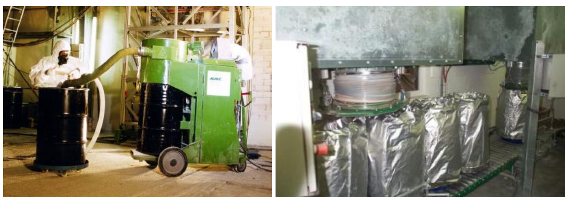
Figure 10 : Reconditionnement de déchets dans des fûts, avec un aspirateur manuel (gauche) ou une station de remplissage automatique (droite).
